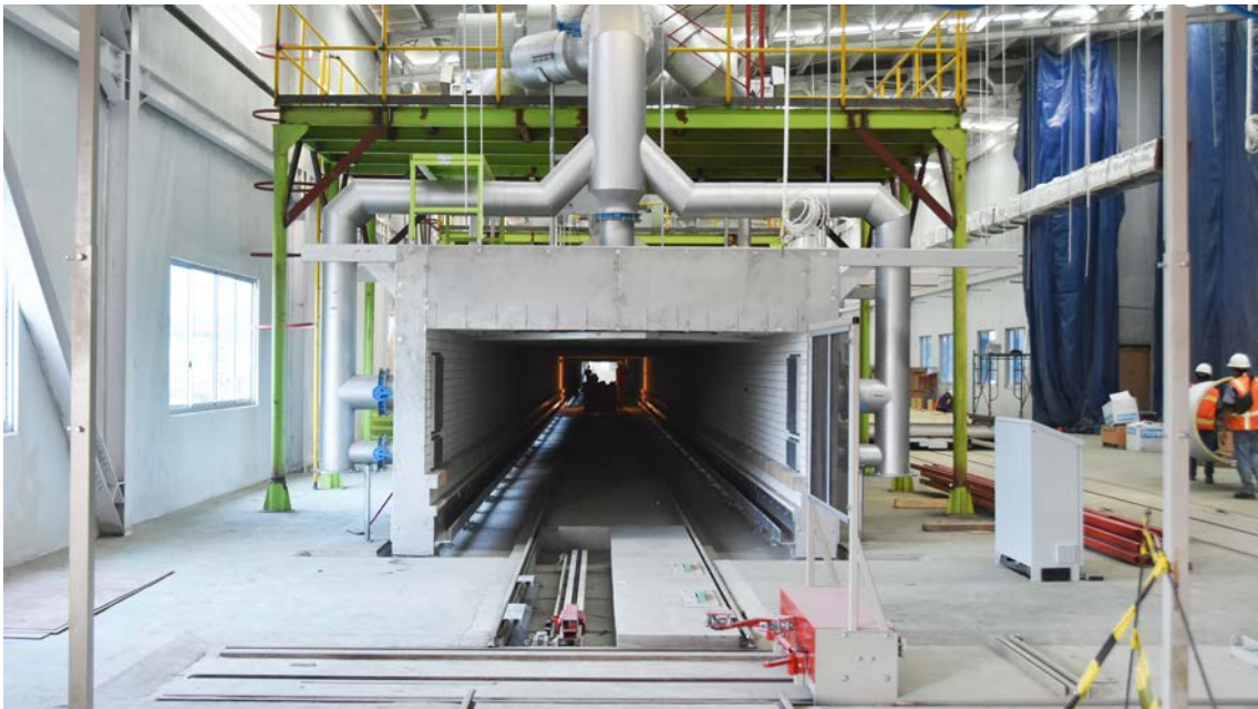
German Kiln Installation of PT Surya Pertiwi Nusantara, Gresik. Instalasi Kiln Buatan Jerman di PT Surya Pertiwi Nusantara, Gresik.
